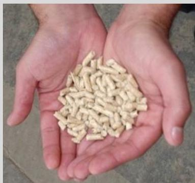
Топливные гранулы (пеллеты) – это биотопливо, получаемое из торфа, древесных отходов и отходов сельского хозяйства. Представляет собой цилиндрические гранулы стандартного размера. Сырьем для производства гранул могут быть торф, балансовая (некачественная) древесина и древесные отходы: кора, опилки, щепы и другие отходы лесозаготовки, а также отходы сельского хозяйства: отходы кукурузы, солома, отходы крупяного производства, лузга подсолнечника, куриный помет и т.д.
