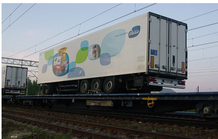
Рис. 2.13. Автомобильный полуприцеп, перевозимый как контрейлер
