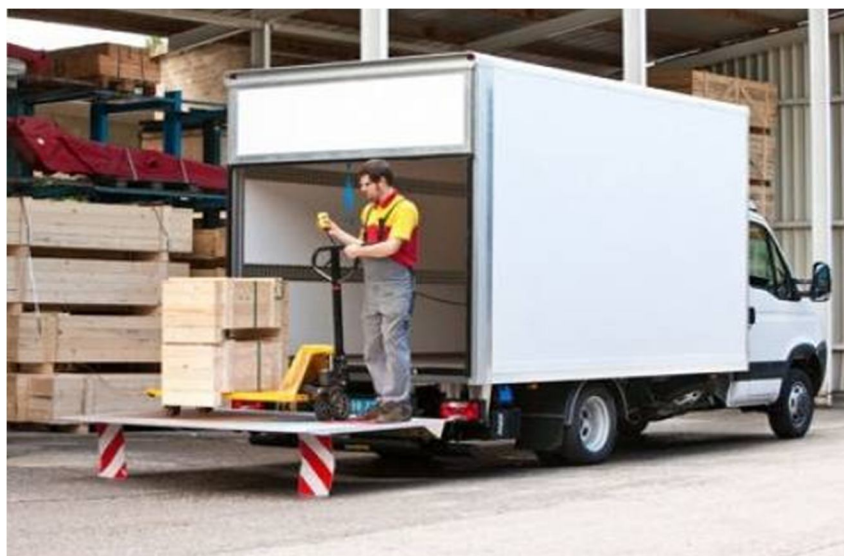
Рис. 2.12. Малотоннажный фургон с грузоподъемным бортом
