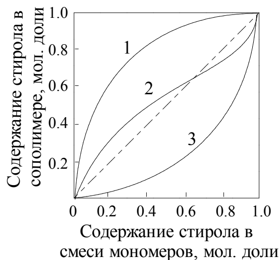
Рис. 2.8. Зависимость состава сополимера от состава исходной смеси мономеров при сополимеризации стирола с метилметакрилатом различными способами:
