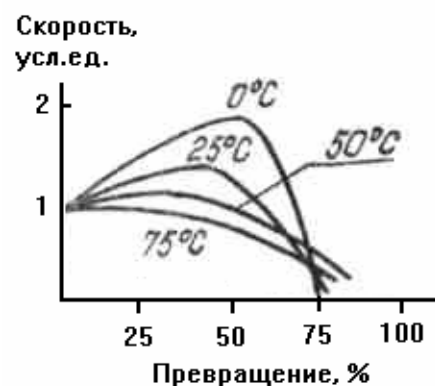
Рис. 2.5. Изменение скорости полимеризации мономера в зависимости от глубины превращения при различных температурах
