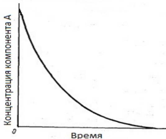
Рис. 3. Кинетическая кривая зависимости концентрации реагента А от времени
