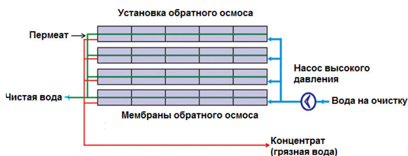
Рис. 8. Базовая модель обратноосмотической установки серии ДВС-М
