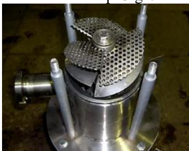
Рис. 9. Гомогенизатор-диспергатор РПГ-7,5 Gidromix, двухступенчатый
