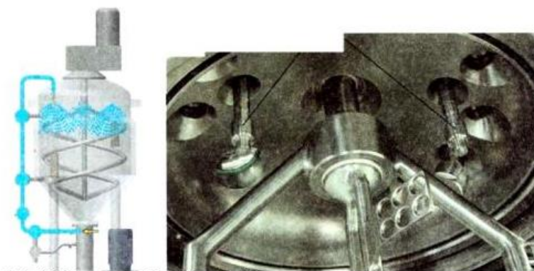
Рис. 50. SIP-форсунки для безразборной мойки аппарата на месте
