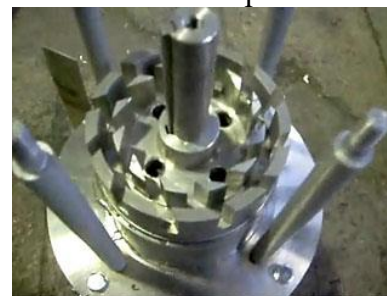
Рис. 9. Гомогенизатор-диспергатор РПГ-7,5 Gidromix, двухступенчатый
