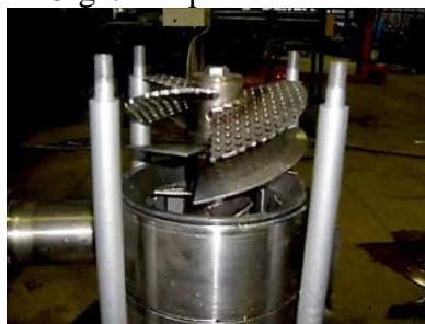
Рис. 9. Гомогенизатор-диспергатор РПГ-7,5 Gidromix, двухступенчатый
