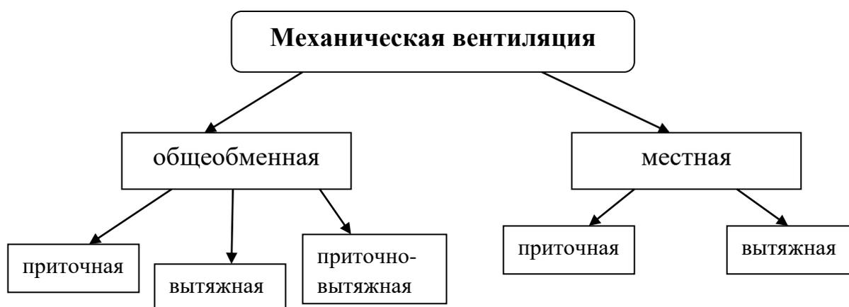
Рис. 4.2. Классификация систем механической вентиляции
