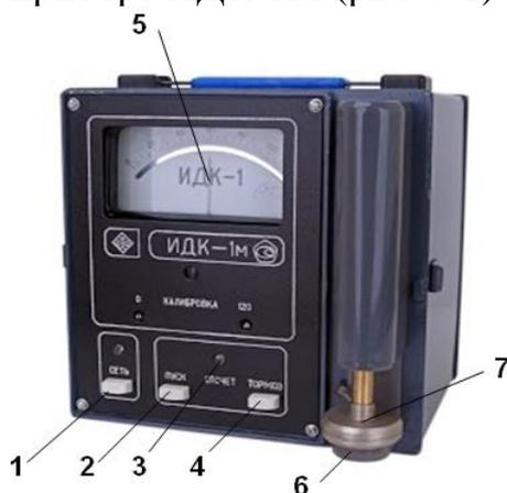
Рис. 3.1. Внешний измерителя деформации клейковины ИДК-1М: 1 – кнопка «СЕТЬ»; 2 – кнопка «ПУСК»; 3 – индикатор «ОТСЧЕТ»; 4 – кнопка «ТОРМОЗ»; 5 – индикаторная стрелка; 6 – опорный столик; 7 – пуансон
