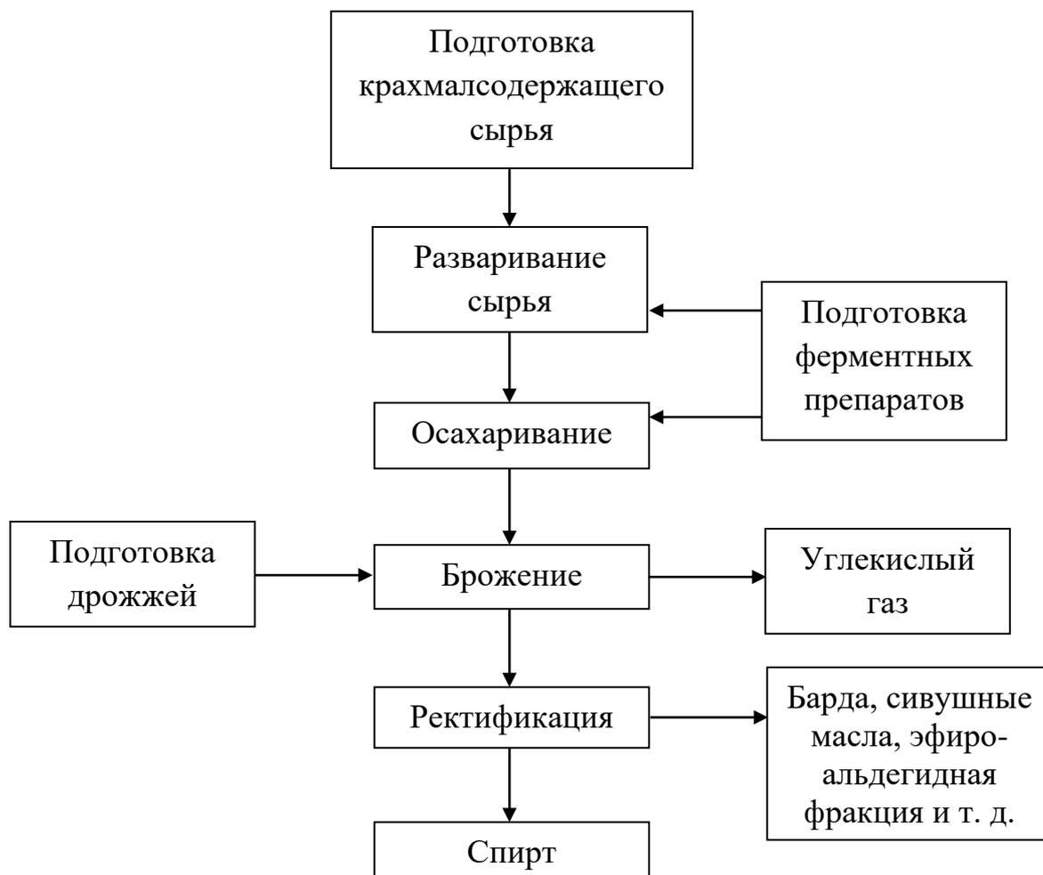
Схема 5.6. Блок-схема производства этанола
