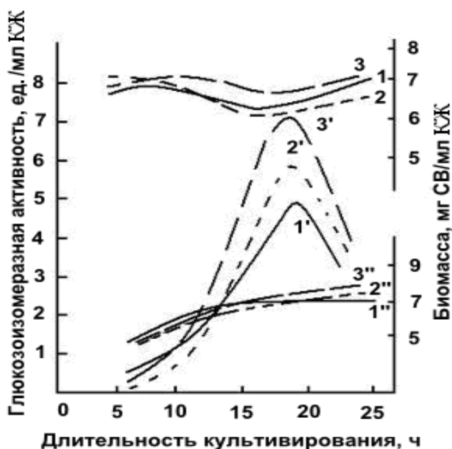
Рис. 7.4. Биосинтез глюкоизомеразы S. Albogriseolus 20-3 (по данным А.В. Гавристова, 1980): 1, 2, 3 – изменение pH среды; 1', 2', 3' – глюкоизомеразная активность; 1'', 2'', 3'' – накопление биомассы. Аэрация составляет соответственно 0,5 (кривые 1, 1', 1''), 1,0 (кривые 2, 2', 2'') и 1,5 (кривые 3, 3', 3'') м 3 /(м 3 ·мин)
