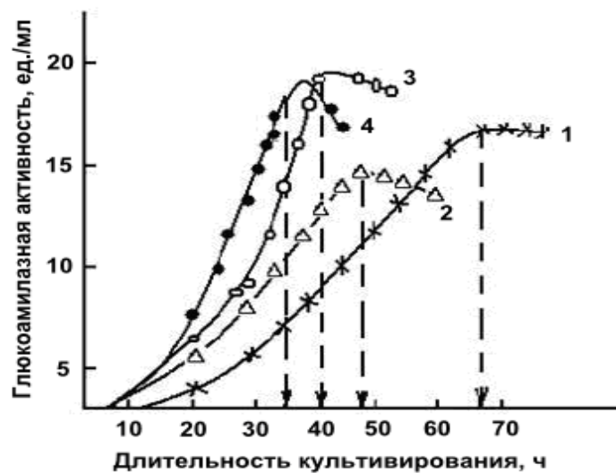
Рис. 7.6. Влияние аэрирования на длительность культивирования Endomycopsis sp. 20-9 и биосинтез глюкоамилазы: 1 – выращивание на круговой качалке (объем среды 100 мл, объем колбы 750 мл); 2, 3, 4 – выращивание в ферментаторе при степени аэрирования 30 л/(л·ч) (2), 50 л/(л·ч) (3) и 60 л/(л·ч) (4)
