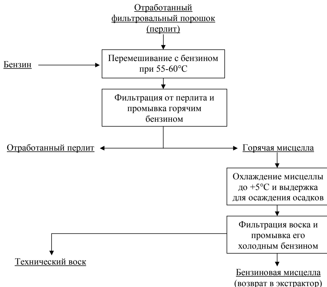
Рис. 1.12. Схема выделения воска из фильтрующего порошка
