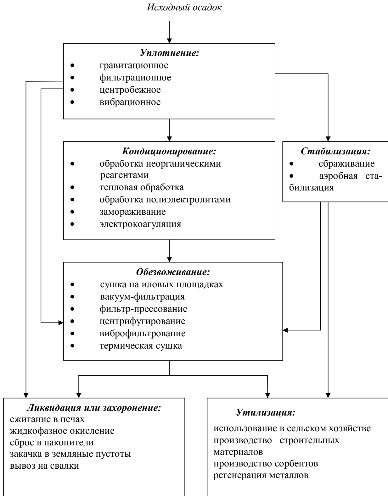
Рис. 3.28. Схема обработки осадка [165]
