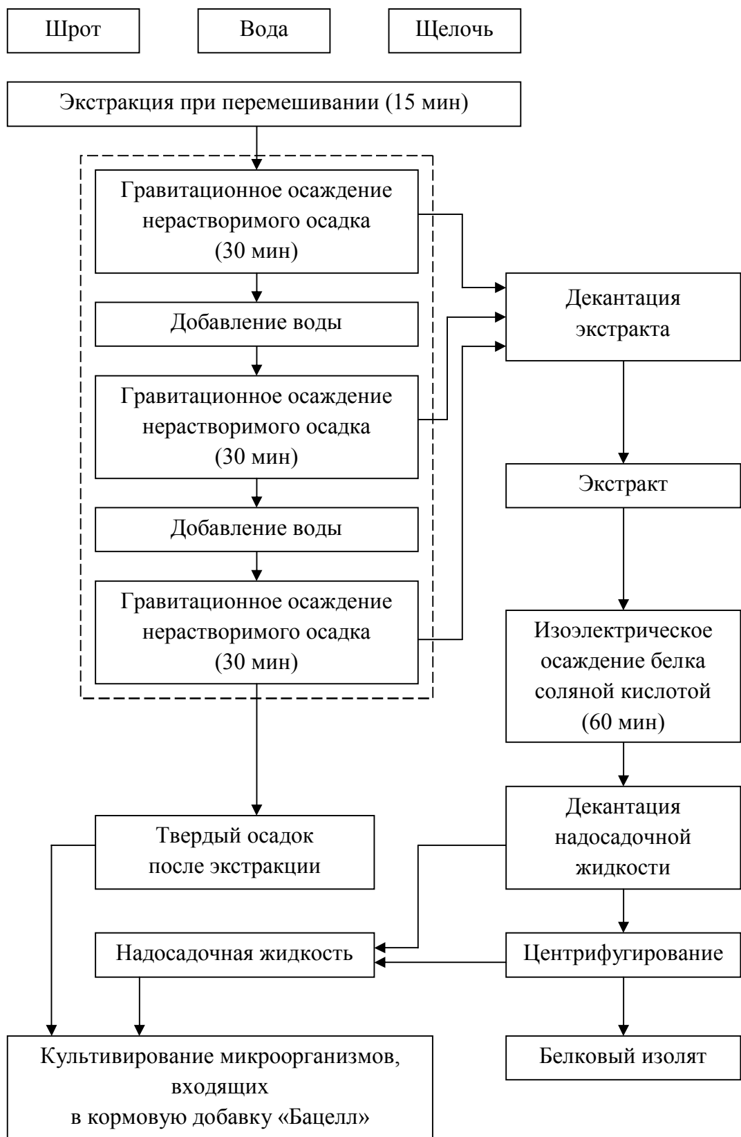
Рис. 1.6. Технологическая схема безотходной переработки подсолнечного шрота
