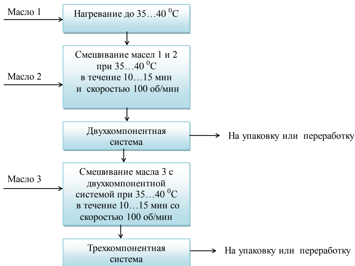
Рис. 4.5. Общая схема получения купажированных масел
