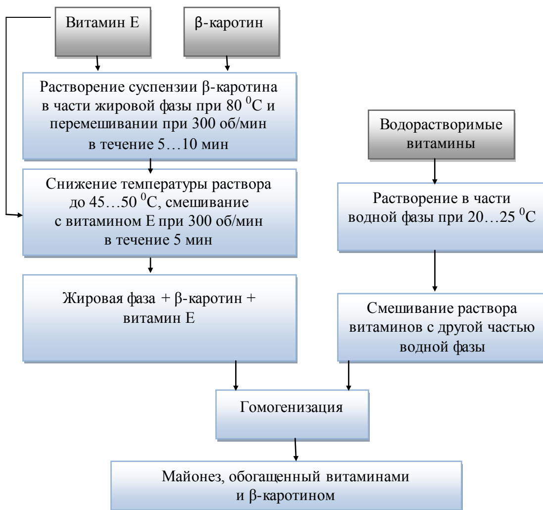
Рис. 4.8. Схема витаминизации майонезов
