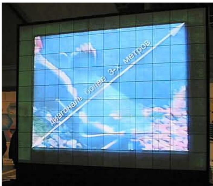
Основными достоинствами плазменных цветных экранов по сравнению с основанными на других технологиях, являются: возможность показа полноцветного телевизионного и компьютерного изображений высокого качества, широкий угол обзора, малая толщина (около 10 см), отсутствие геометрических искажений, вредных излучений, проблем с чистотой цвета и мерцанием изображения.
