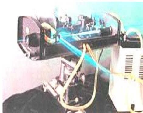
Жидкостный лазер на красителях. Справа - насос, прокачивающий жидкость через холодильник.
