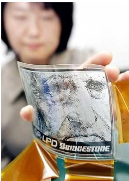
*Рис. 2.51 Жидкопорошковый дисплей*
