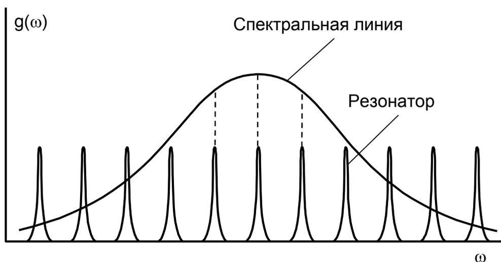
Рис. 1.11. Естественная ширина линии и моды резонатора
