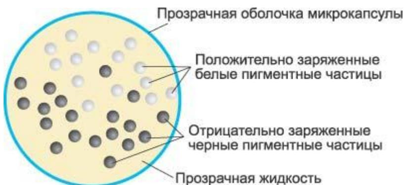
*Рис. 2.46. Микрокапсула — основной структурный элемент дисплеев на базе электронных чернил*
