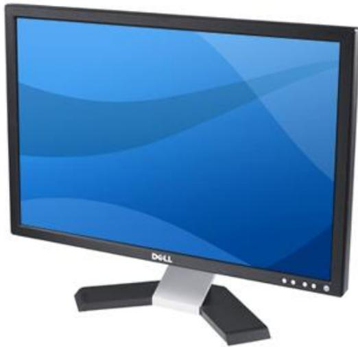
Монитор работает с разрешением UXGA (1680×1050 пикселей). Видимая область изображения соответствует видимой области стандартного 21-дюймового ЭЛТ-монитора. В устройстве используется матрица с максимальной контрастностью 800:1, яркостью 300 кд/м<sup>2</sup>, шаг пикселя – 0,282 мм, время отклика – 5 мс. Угол обзора как по горизонтали, так и по вертикали составляет 170 градусов.
