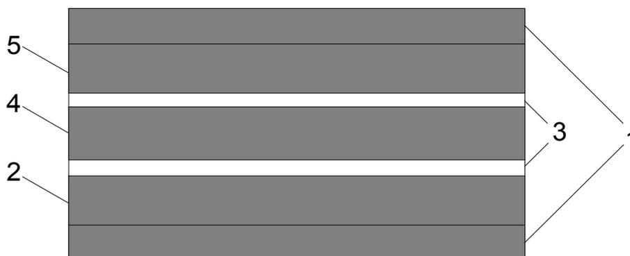
*Рис.2.11. Схема оптопары. 1 - металлические электроды; 2 – светоизлучатель; 3 - прозрачные электроды (оксид олова); 4 - оптическая среда (стекло или полимер); 5 – фотоприемник*
