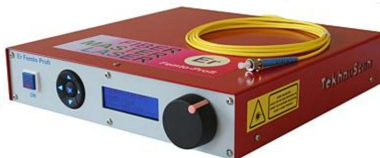
Мощный волоконный лазер, в случае оснащения его оптическим переключателем, может обслуживать сразу несколько (2...6) технологических установок (рис. 1.21).
