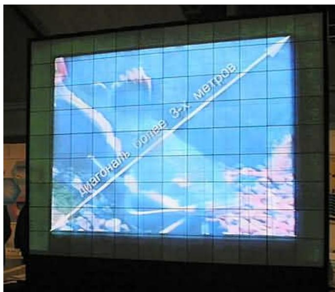
*Рис. 2.37. Наборная плазменная панель диагональю более 3-х м.*
