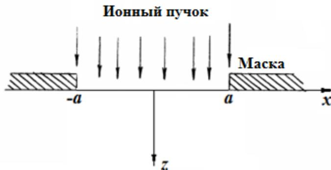
Рис. 4.8. Геометрия окна и система координат для моделирования
