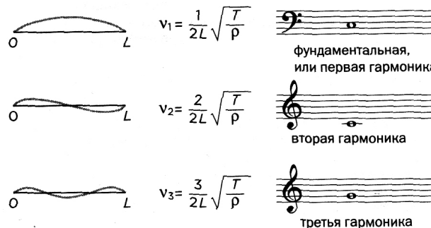
Рис. 17. Демонстрация принципа частотного квантования при возникновении стоячих волн музыкальной струны
