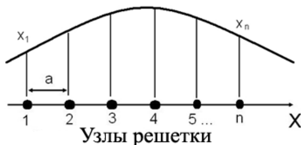
Рис. 20. Демонстрация принципа представления непрерывной функции своими значениями в виде совокупности точек на дискретной решетке
