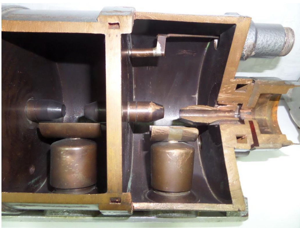
Рис. 17. Вид клистрона, изготовленного из меди, в разрезе: а - внутреннее устройство клистрона; б - более крупное изображение вывода энергии и части коллектора
