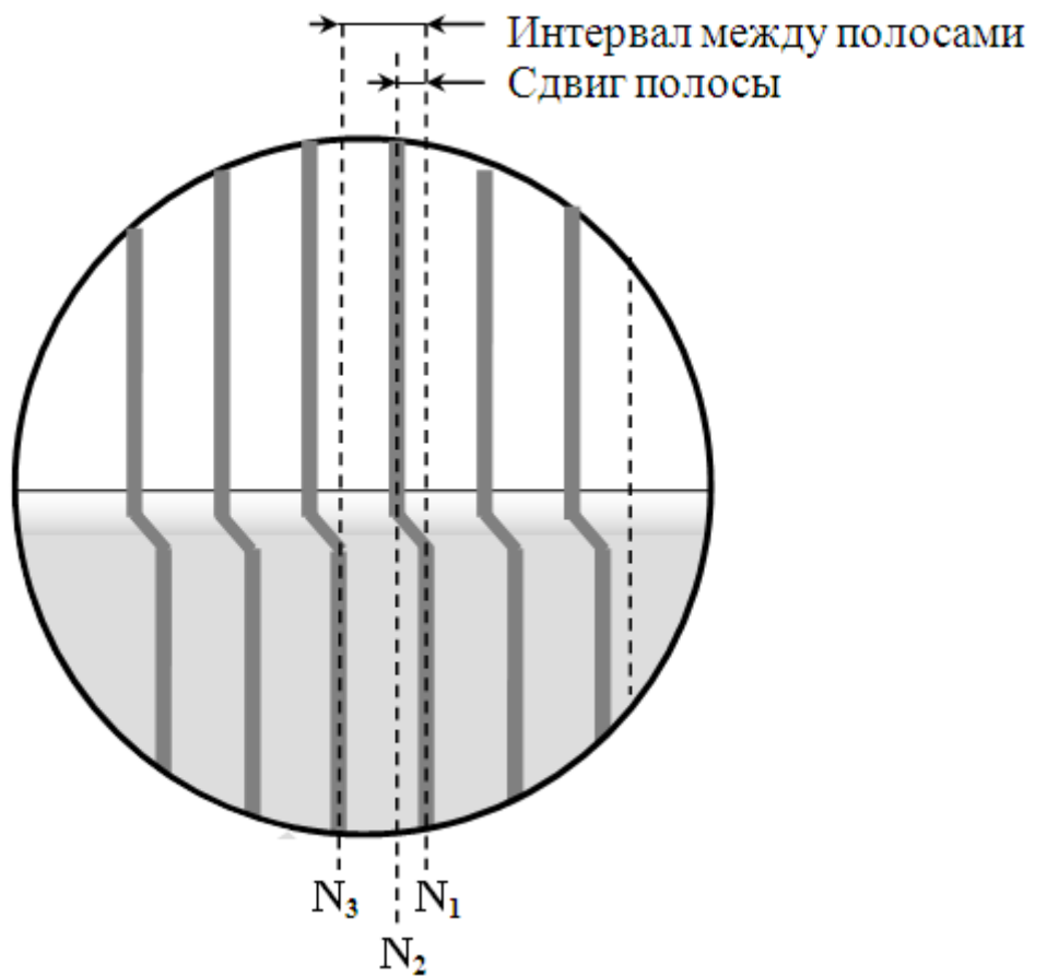
Рис. 26. Изображение границы перехода Si-SiO 2 в монохроматическом свете в режиме работы «микроинтерферометр»
