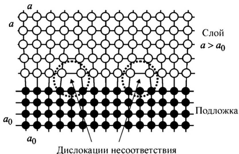
Рис. 10. Построение атомов подложки и эпитаксиального слоя при метаморфном росте кристалла: a_0 и a – постоянные решеток подложки и эпитаксиального слоя
