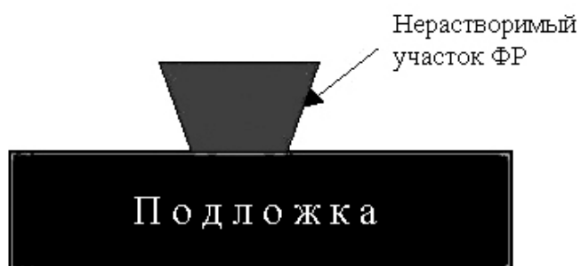
Рис. 45. Результат проявления пленки позитивного фоторезиста после обращения скрытого изображения (формирование негативного изображения фотошаблона с отрицательным наклоном стенок)
