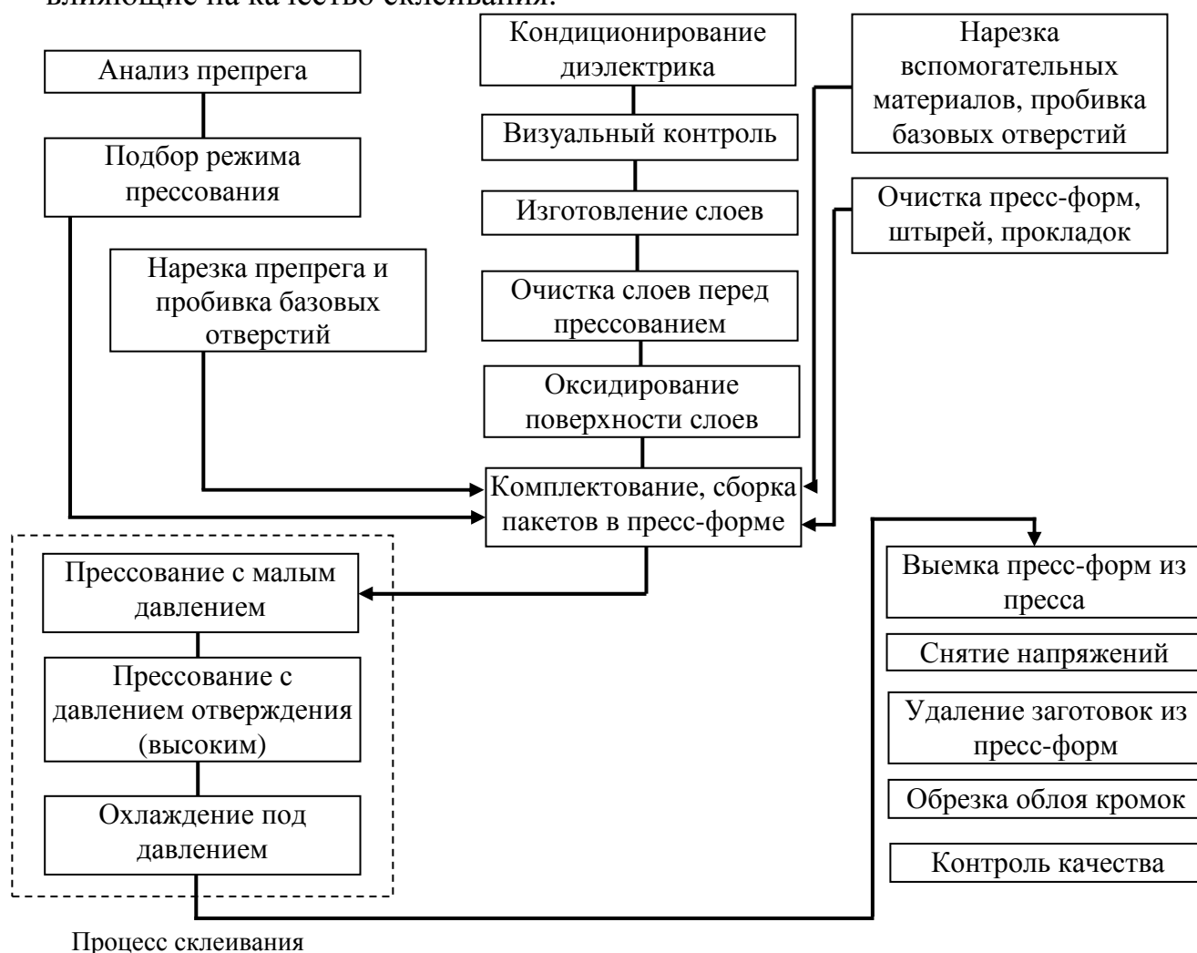
Рис. 75. Последовательность процесса прессования
