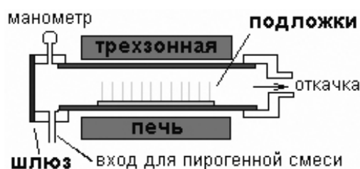
Рис. 17. Схема установки пиролитического осаждения при пониженном давлении
