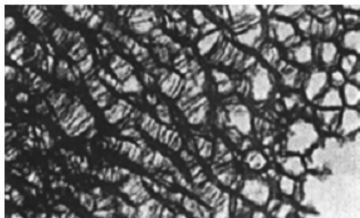
Рис. 2. Микроструктура пористого кремния на p -Si.
