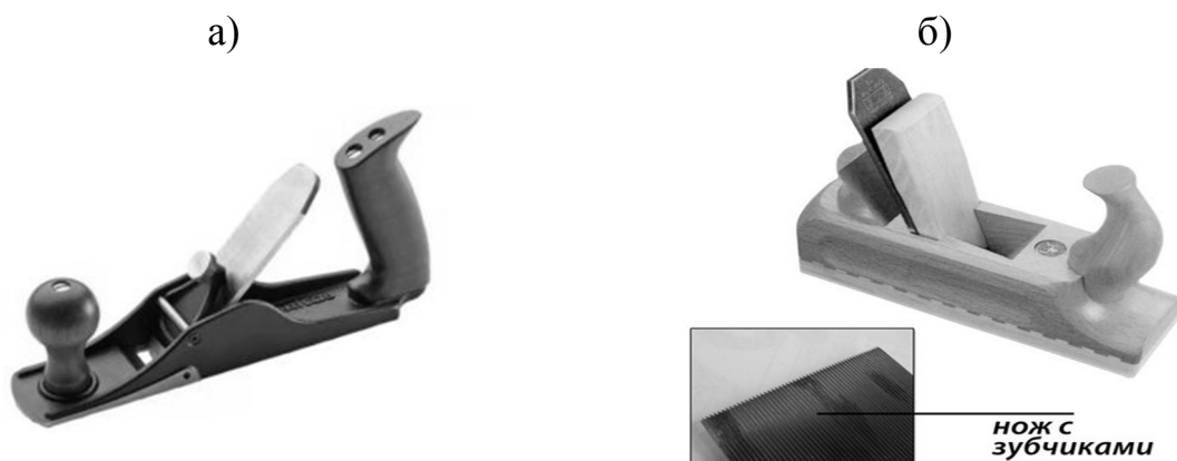
Рис. 9.6. Инструменты для шлифовки: а – шерхебель; б – цинубель
