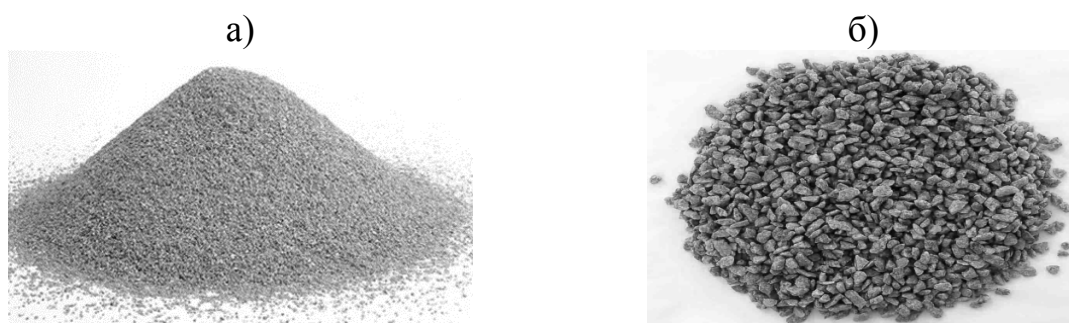
Рис. 8.4. Примеры мелкого заполнителя: а – природный песок; б – гранитная крошка
