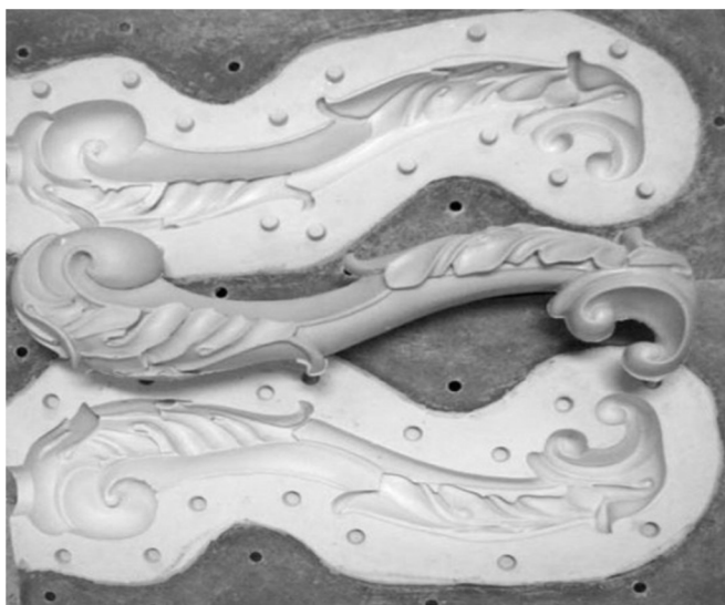
Рис. 9.10. Форма и изделие на основе литьевого мрамора
