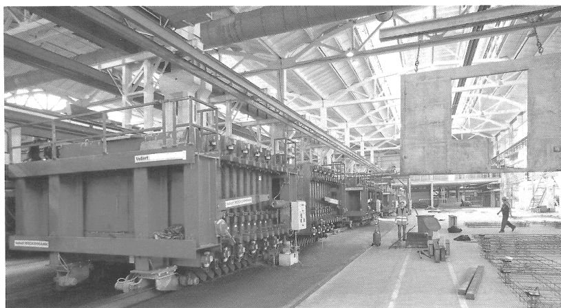
Рис. 4.11. Кассетно-конвейерный способ производства ЖБИ
