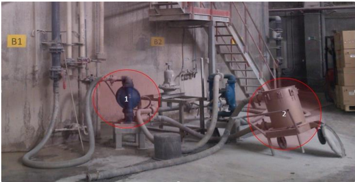
Рис. 4.7. Мембранный насос – 1, корзинчатое сито – 2
