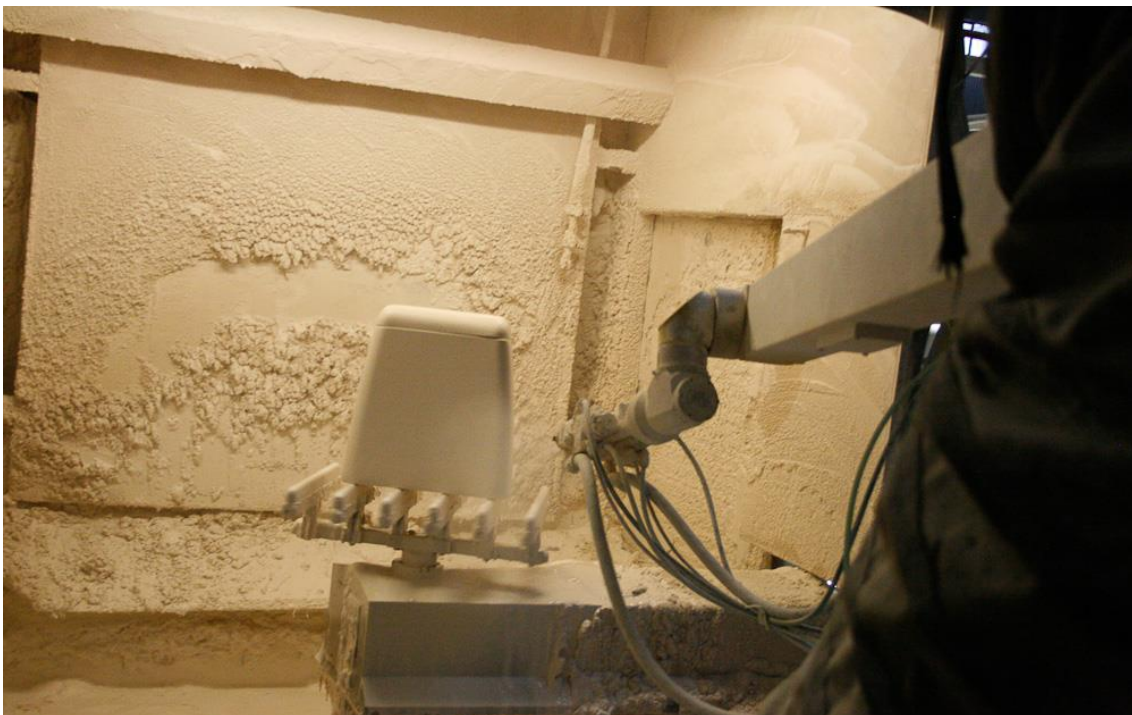
Рис. 4.22. Глазурование изделий с помощью установки «Робот» методом пульверизации
