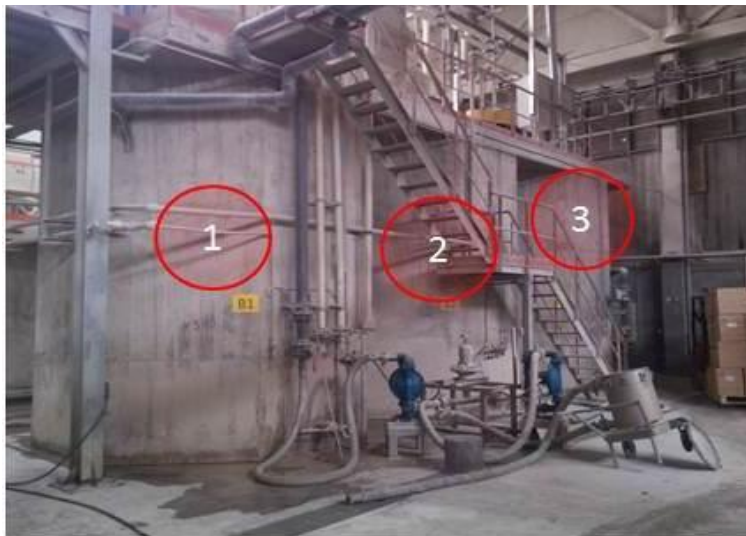
Рис. 4.8. Турбодробилки – 1, 2, расходный бассейн – 3
