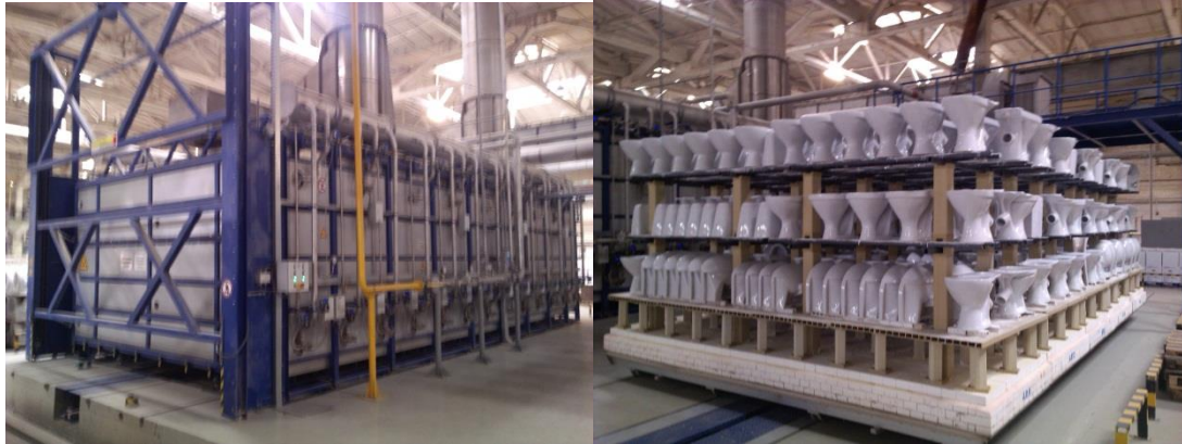
Рис. 4.29. Печь периодического действия и вагонетка для нее
