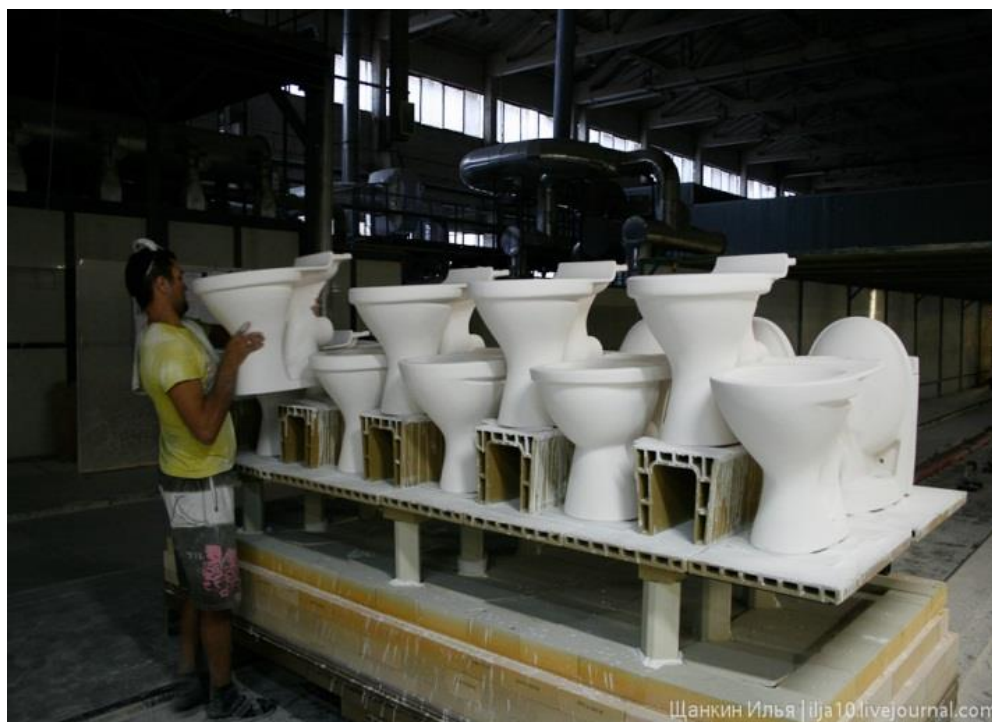
Рис. 4.23. Ставка глазурованных изделий на печную вагонетку
