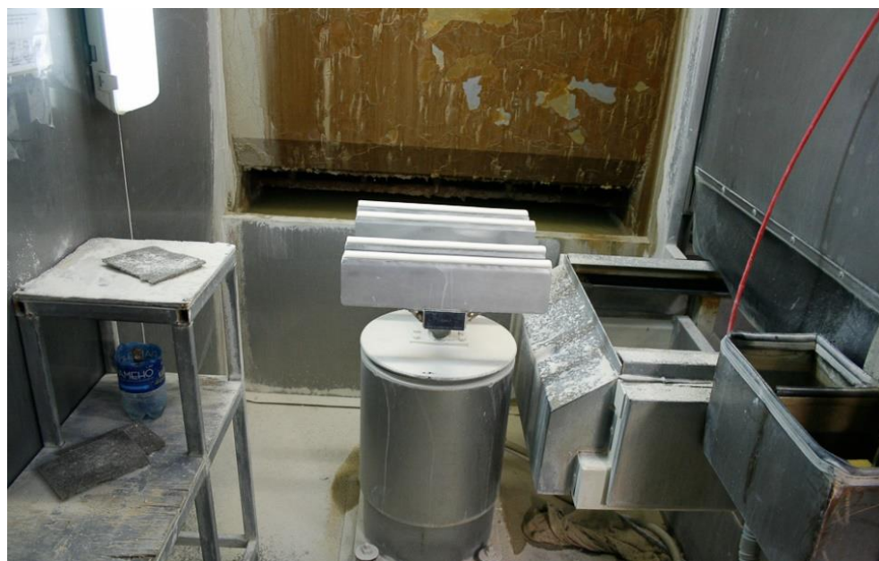
Рис. 4.19. Кабина оправщика (вид изнутри)
