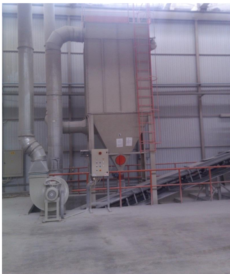
Рис. 4.3. Конвейер закрытого типа, оснащённый циклоном
