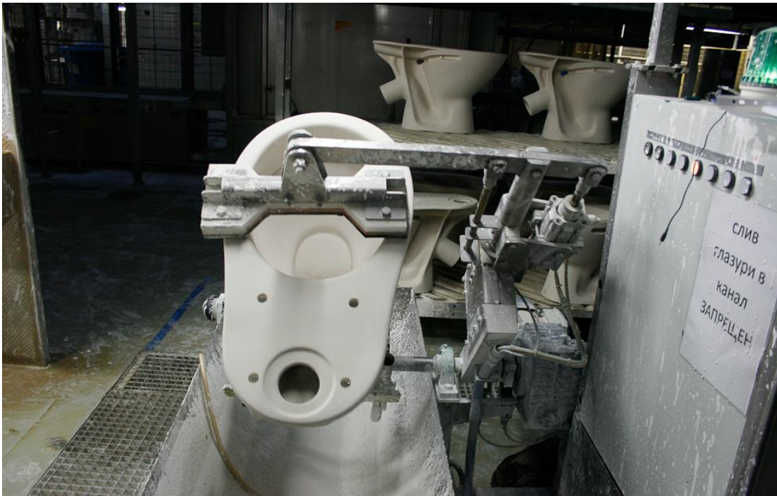
Рис. 4.21. Глазурование сифона унитаза методом полива
