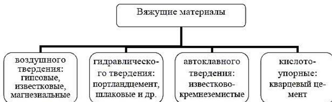
Рис. 1.4. Классификация строительных вяжущих материалов
