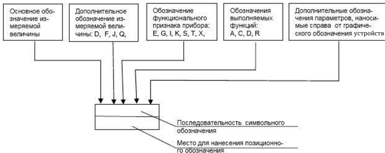
Рис.17. Принцип построения условного обозначения прибора
