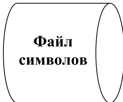
Рис. 1. Обозначение операций с файлом на блок-схеме.
