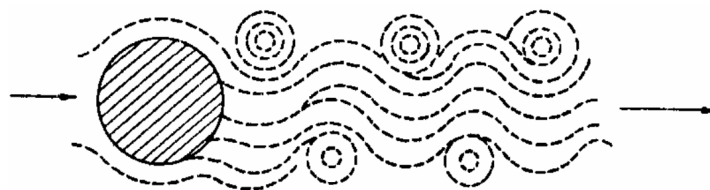
Рис. 50. Образование вихрей Кармана в потоке
