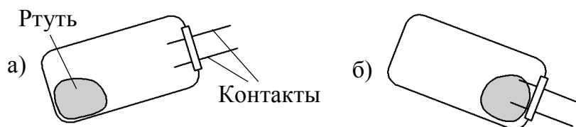
Рис. 2. Гравитационный датчик: а – ртутный переключатель в разомкнутом состоянии; б – ртутный переключатель в замкнутом состоянии
