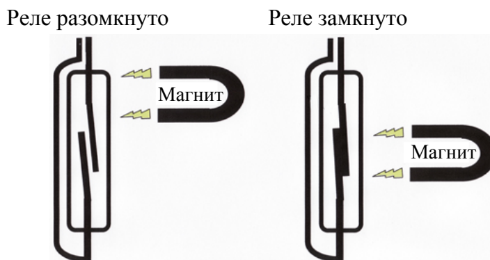
Рис. 8. Принцип действия герконового реле
