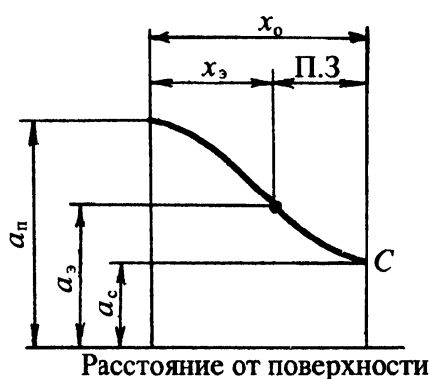
Рис. 40. Схема диффузионного слоя: П.З — переходная зона; C — сердцевина; x_0 — общая толщина диффузионного слоя; x_э — эффективная толщина диффузионного слоя; a_п — значение базового параметра у поверхности; a_э — предельное значение базового параметра, установленное для эффективной толщины; a_c — значение базового параметра для сердцевины
