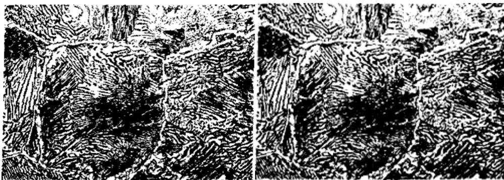
Рис. 11. Микроструктура инструментальной углеродистой стали: светлая каемка по границам зерен - цементит; остальное - перлит
