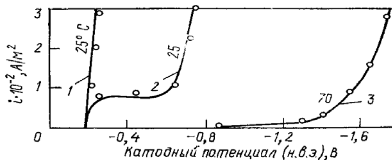
Рис. 3.5. Поляризационные кривые электроосаждения олова из кислых и щелочных электролитов при 25 °С:
