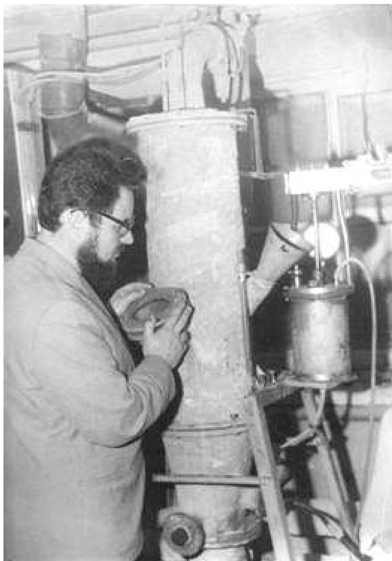
«Испытатель» доцент Ю. Г. Широков. Пробный пуск установки по испытанию катализатора в кипящем слое, 1970 год
