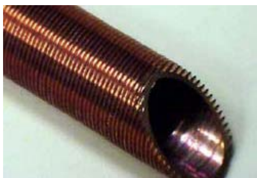
Рис.1.7. Теплообменная трубка с канавками на наружной поверхности
