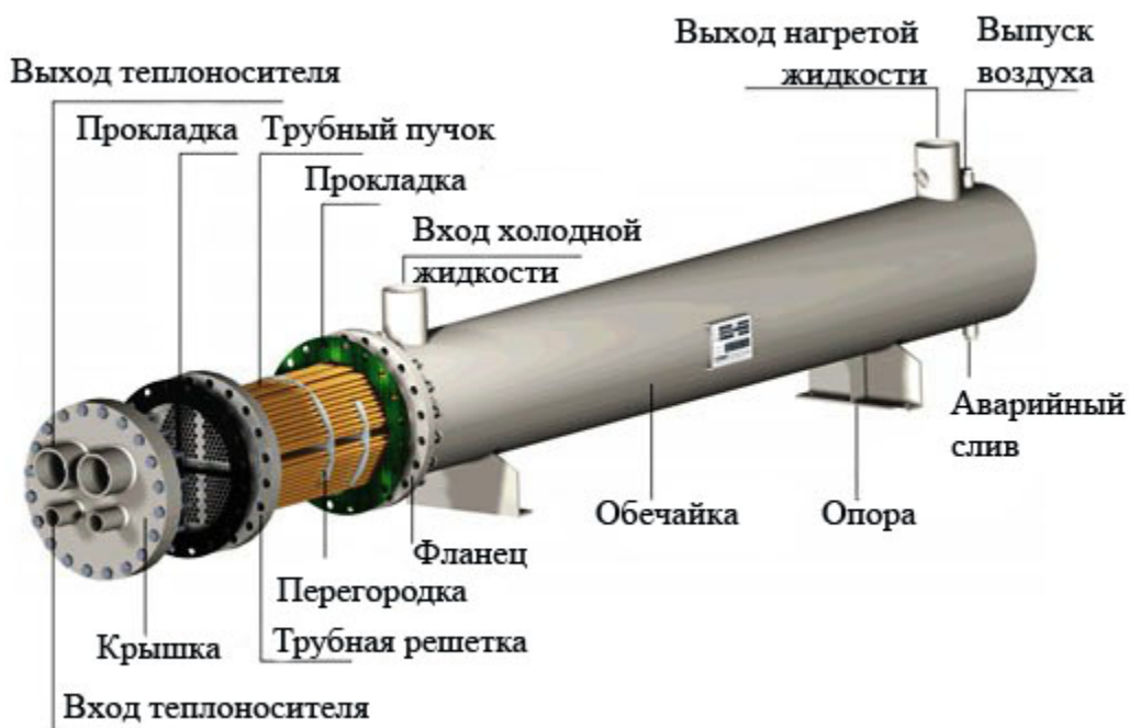
Рис. 1.1. Кожухотрубчатый теплообменник
