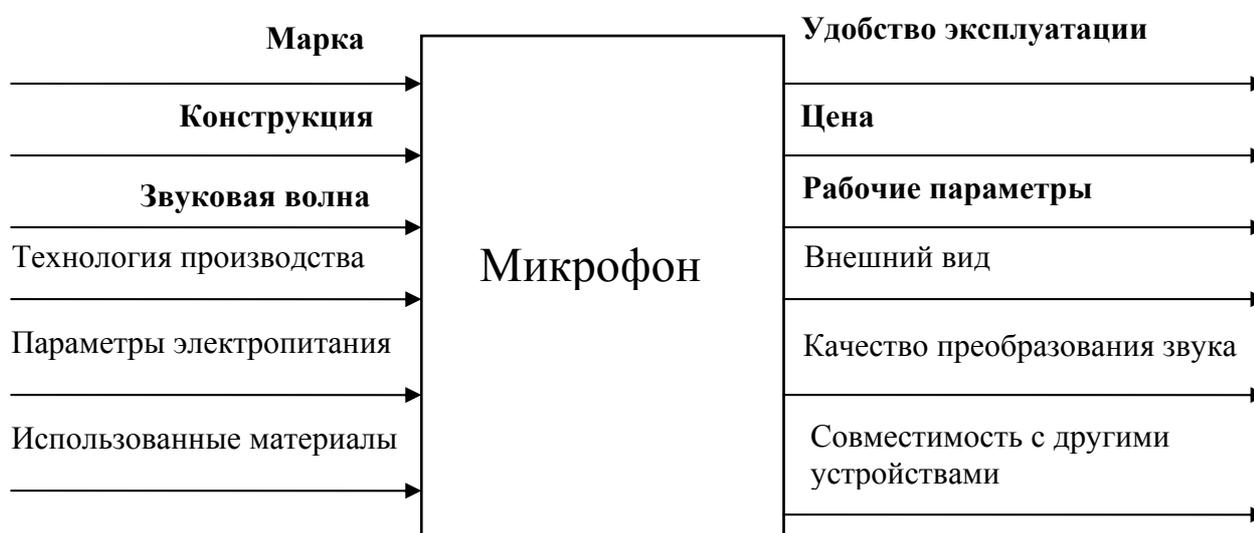
Рис. 1.3. Модель «черного ящика» для системы микрофон
