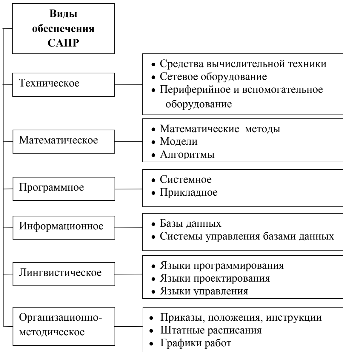
Рис. 4.1. Структура основных видов обеспечения САПР
