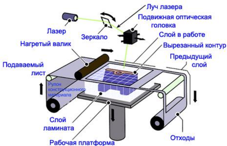
Рис. 5.7. Схема LOM процесса
