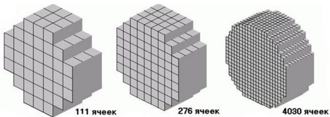
Рис. 6.5. Ячеечное представление твердых тел
