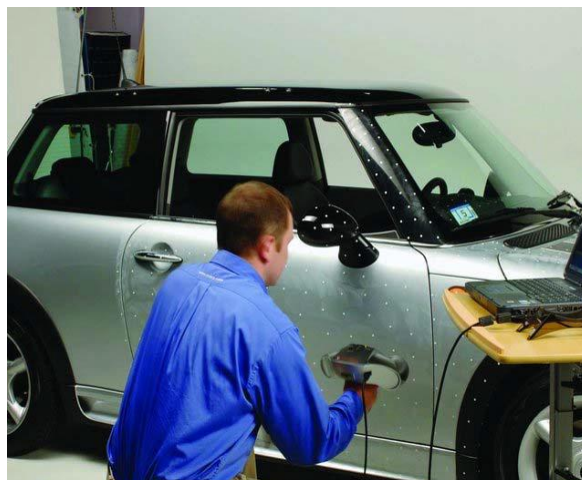
Рис. 5.14. Бесконтактный 3D сканер: а – принцип действия, б – работа с ним
