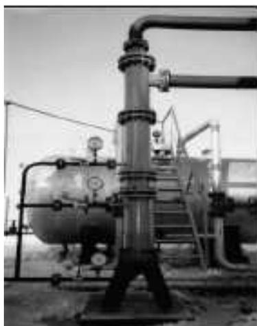
Рис. 43. Установка для разделения газа
