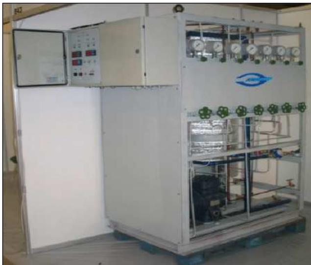
Рис.27. Тепловой насос ТН  $\text{CO}_2$ -20
