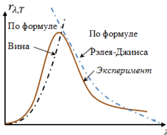
Рис. 5. Зависимость лучеиспускательной способности АЧТ от длины волны
