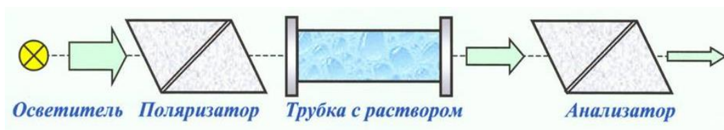
Рис. 17. Схема прохождения монохроматического света через систему \Pi \rightarrow \text{OAB} \rightarrow \text{A}
