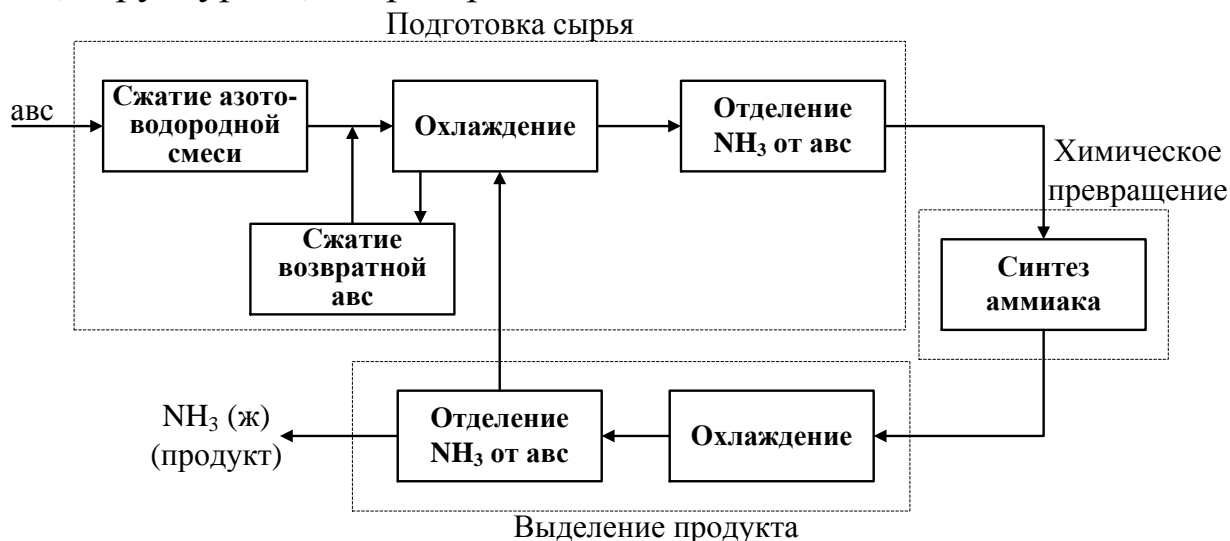
Рис. 1.9. Функциональная схема производства аммиака
