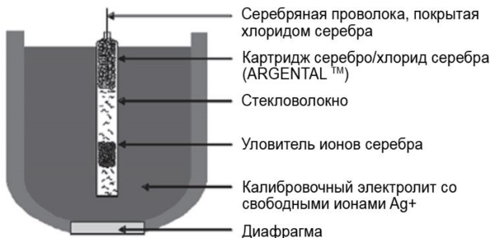
Рис. 1.14. Схема системы сравнения
