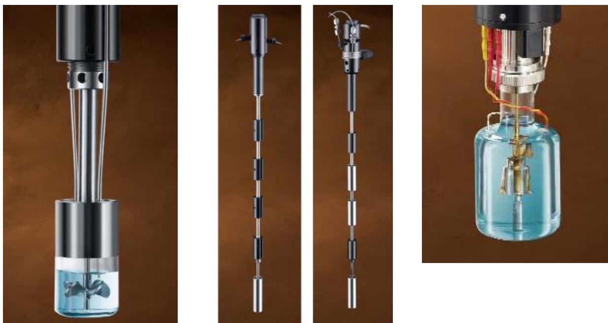
Рис. 2.3. Разновидности ячеек калориметрической системы ТАМ III
