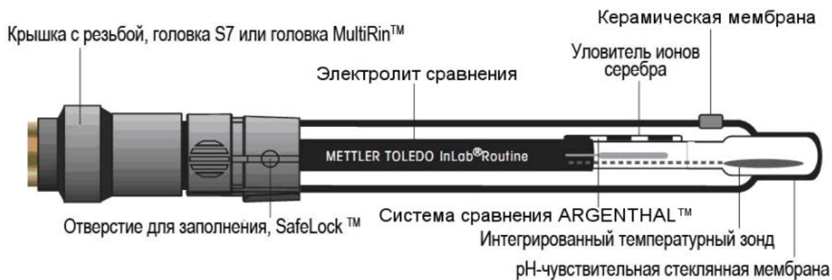
Рис. 1.15. Стандартный комбинированный pH-электрод со встроенным pH-сенсором и внешним элементом сравнения
