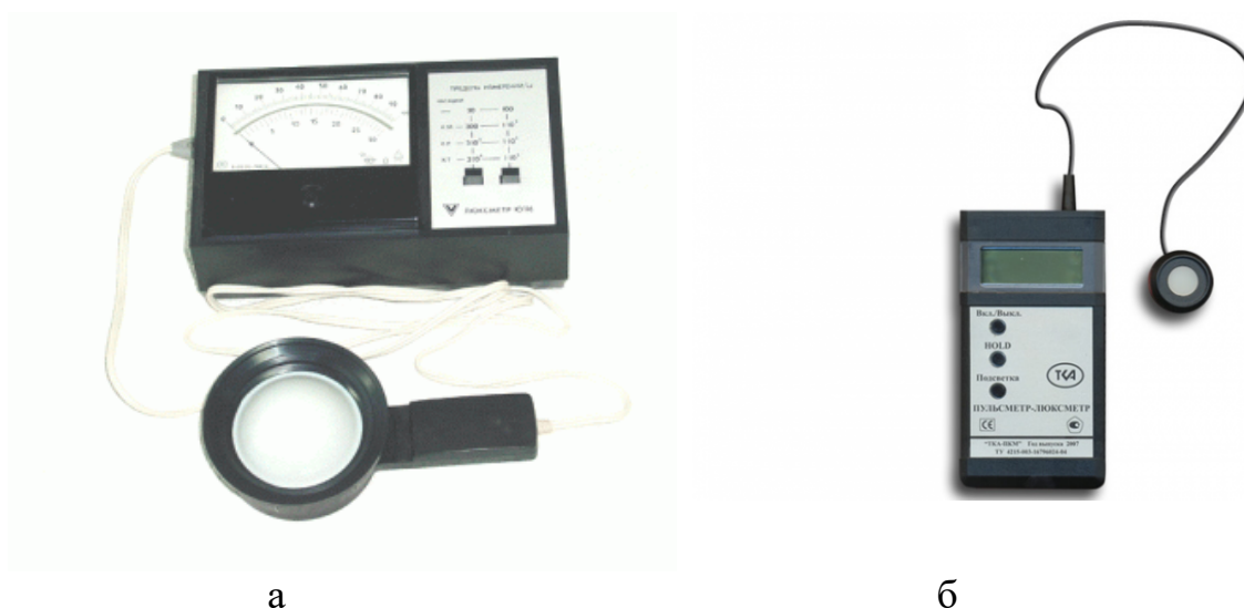
Рис. 3. Приборы контроля уровня освещенности и коэффициента пульсации освещенности на рабочих местах: а – люксметр; б – пульсметр-люксметр
