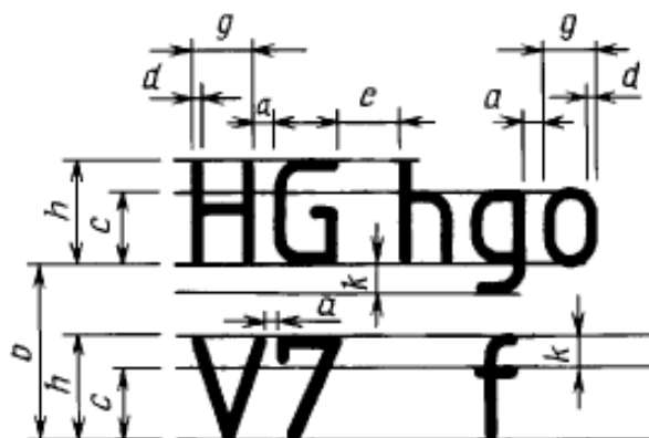
Рис. 1.9. Шрифт без наклона
