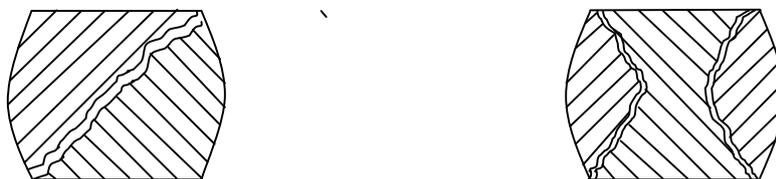
Рис. 33. Схема разрушения хрупкопластичных материалов при сжатии
