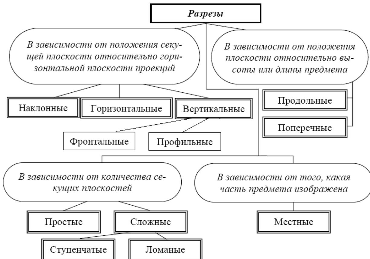
Рис. 2.14. Классификация разрезов
