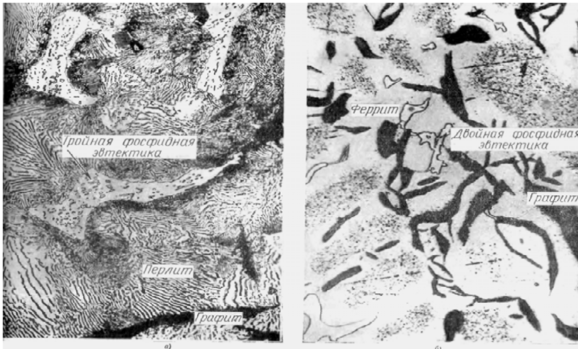
Рис. 34. Фосфидная эвтектика в сером чугуна, отличающаяся износостойкостью, твердостью и хрупкостью; x1000: а – тройная ( \text{Fe}_3\text{P} - \text{Fe}_3\text{C} - \text{Fe} ); б – двойная ( \text{Fe}_3\text{P} - \text{Fe} )
