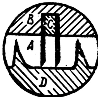
Рис.58. Лабиринтное уплотнение с гребенчатыми остриями.
