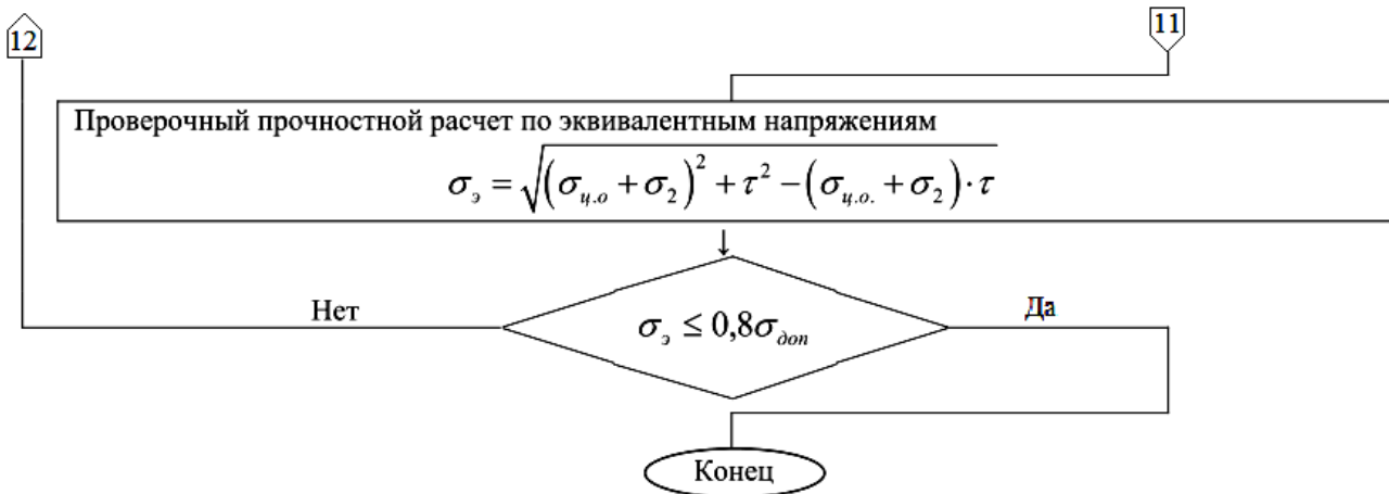
Рис. 2.3. Блок-схема алгоритма расчета горизонтального аппарата с кольцами жесткости
