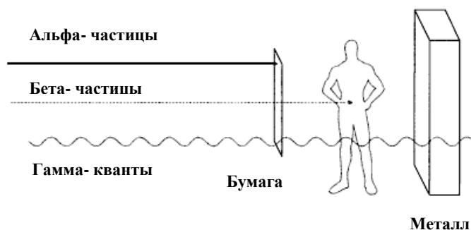
Рис. 3.11. Схематическое изображение проникающей способности различных излучений
