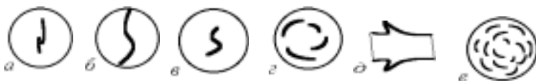
Рис. 2.5. Дефекты экструдатов: a — прямая трещина в центре бруса; b — S-образная трещина в центре экструдата; c — малая S-образная трещина в центре экструдата; z — эллипсоидные трещины по сечению экструдата («свиль»); d — нарушение поверхности экструдата («драконов зуб»); e — расслоение по всему объему массы
