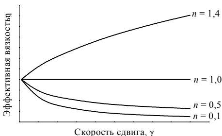
Рис. 1.9. Реологические кривые при разных значениях индекса течения
