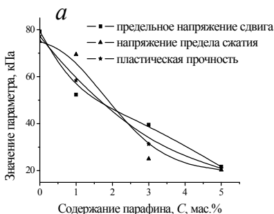
Рис. 1.18. Значения пластической прочности, напряжения предела сжатия, предельного напряжения сдвига от содержания парафина в формовочных массах на основе: a — \text{Al}(\text{OH})_3 - \text{HNO}_3 ; б — \gamma\text{-Al}_2\text{O}_3 - \text{HNO}_3
