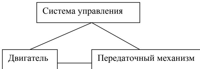
Рис. 3.1. Схема привода
