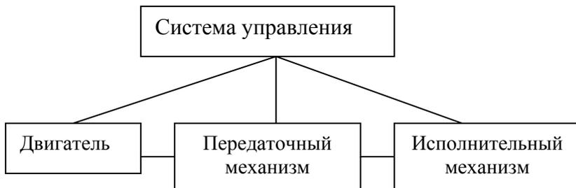
**Рис. 3.2 Составные части машины**
