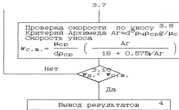
4.2. Блок-схема алгоритма конструктивного расчета
