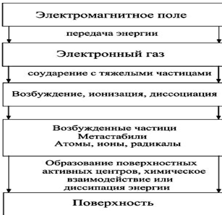
Рис. 1.3. Схема процессов активации в плазме низкого давления
