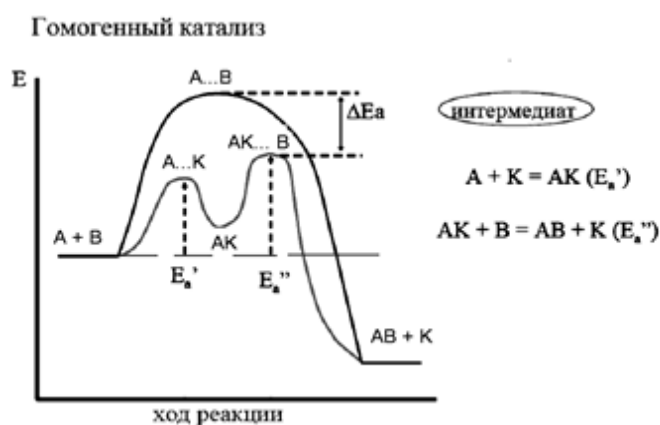
Рис. 18. Энергетическая диаграмма гомогенной реакции: без катализатора и с катализатором
